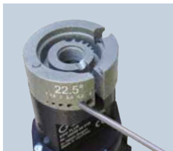
Ostření elektrod: 4 různé úhly, 6 r úžných průměrů elektrod
