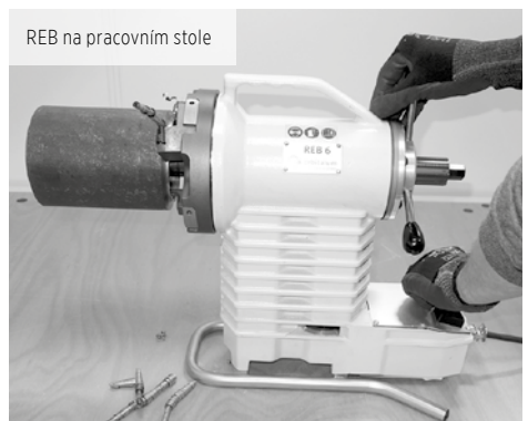
Integrovaná rukojeť umožňuje rychlé dosažení do trubky
