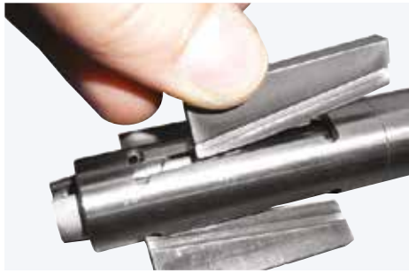
Upínací systém "NC" s upínacími klíny pevně ukotvenými v upínacím trnu je chráněn před ztrátou
