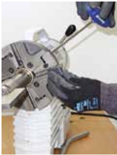
Systém rychlé výměny nástrojů QTC® (Quick-Tool-Change)
