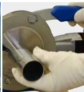
Systém rychlé výměny nástrojů, kruhových upínacích čelistí a trubek
